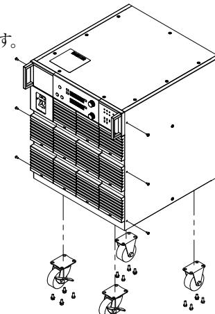
2. ③のねじを使用して①と②のブラケットを図のように取り付けます。
